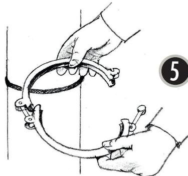
Den Spannring um den drehbaren Zuganker öffnen. Der gesamte Spannring bleibt dabei inklusive Schrauben als Einheit zusammen.
