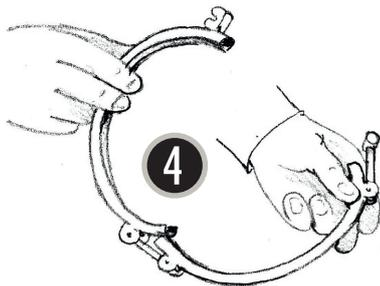
Beide Spannschrauben lösen, aber nicht ganz aus den Zugankern herausdrehen. Einer der Zuganker ist gelb verzinkt bzw. in der Edelstahl-Ausführung mit einer Rille versehen. Diesen Zuganker aushaken.
