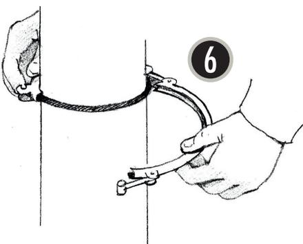
Den Spannring um die zusammengefügte Rohrteile legen und den Zuganker einhängen.
