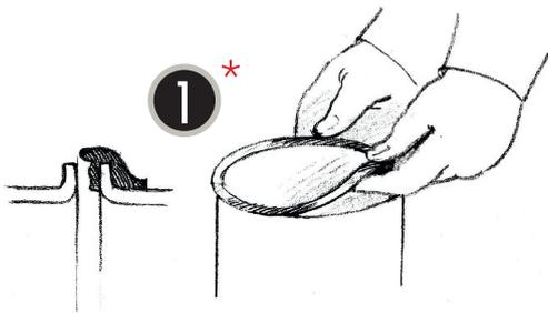
Den Dichtring entsprechend dem Rohrdurchmesser wählen und auf eine der Bördelkanten ziehen. Dabei muss mit der Naht begonnen werden. Die profilierte Seite des Dichtringes muss zum Anschlussrohr zeigen. Beim Aufziehen kann der Dichtring etwas gezogen werden.
